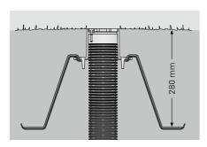
Die Walu-Endkappe dient als universelles, oberflächengleiches Abdeckelement. Über den ausschwenkbaren, verschlusssicheren Deckel ist eine problemlose Belüftung, Bewässerung und Zufuhr von Nährstoffen möglich.
