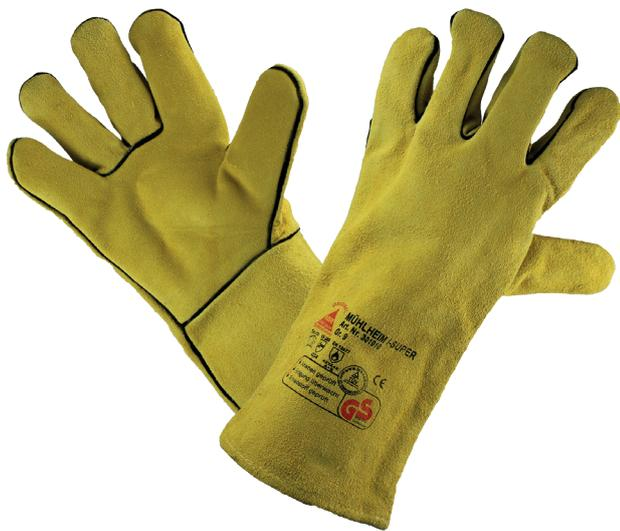
Der gefütterte Schweißerhandschuh! Material: Qualitäts-Rindspaltleder, komplett gefüttert, TÜV GS Schadstoff geprüft, Fingerbeweglichkeit: Leistungsstufe 5, Wasserdampfdurchlässigkeit: 10,4mg/cm<sup>2</sup>h, pH-Hautneutral, Länge: 33-41cm
