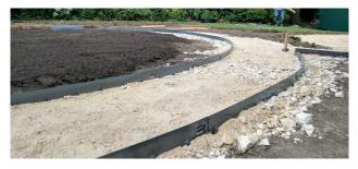
Alle Typen, mit Ausnahme des patinierten Stahls (Cor-ten), sind mit einer 20 Mikrometer dicken galvanischen Zinkschicht überzogen. Die schwarzen (RAL 9005) Abgrenzungen sind mit einer 110 Mikron starken UV-beständigen Polyester-Pulver beschichtung versehen, die Verfärbungen verhindert und eine dauerhafte, strahlungsbeständige Beschichtung bildet, die eine garantierte Lebensdauer von mehr als 20 Jahren hat.
